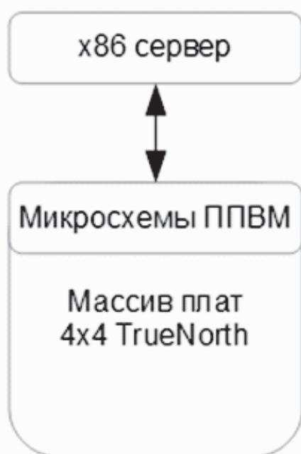
Рис. 4. Схема вычислительной системы на основе нейрокомпьютера
